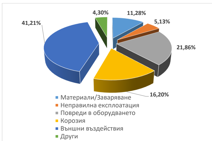
Фиг. 7. Кръгова диаграма на причинно-следствените фактори за повредата на газопреносните тръбопроводи
