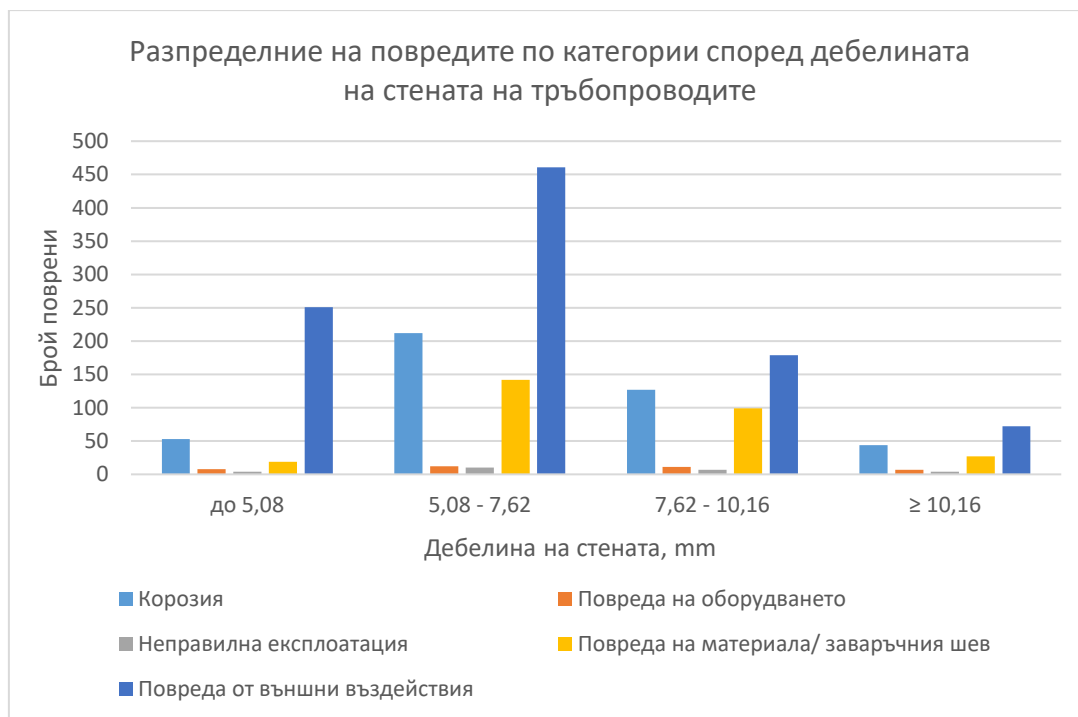
Фиг.10. Разпределение на повредите по категории според дебелината на стената на тръбопроводите
